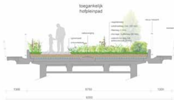
Doorsnede van de toekomstige inrichting van het dak
